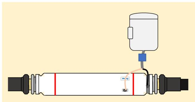
制御機器用プラボックスを用いて内側にITBを設置してください。ITBのコネクト部分（図：青い部分）は交換しやすいよう、ボックスの外に出してください。
