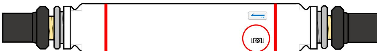
ITBリード線のネジ位置が正面に来るように設置してください
