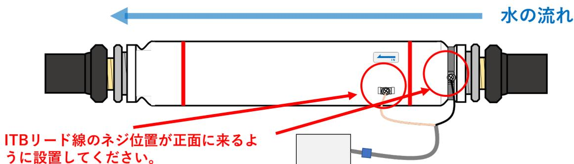
本製品本体のITB接続端子にITBの圧着端子（白線）をつなぎ、本体IN側の首が細くなった部分にITBリング（黒線）を取り付けて固定します。
