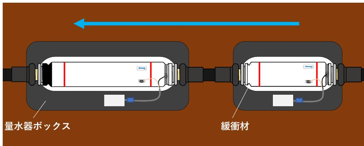
本製品本体のITB接続端子にITBの圧着端子（白線）をつなぎ、本体IN側の首が細くなった部分にITBリング（黒線）を取り付けて固定します。ブースターも同様にITBを取り付けます。
