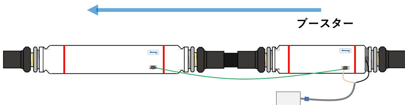
ブースターのITB接続端子にITBの圧着端子（白線）をつなぎ、IN側の首が細くなった部分にITBリング（黒線）を取り付けて固定します。また、本製品本体及びブースターのITB接続端子同士を接続配線で接続します。
